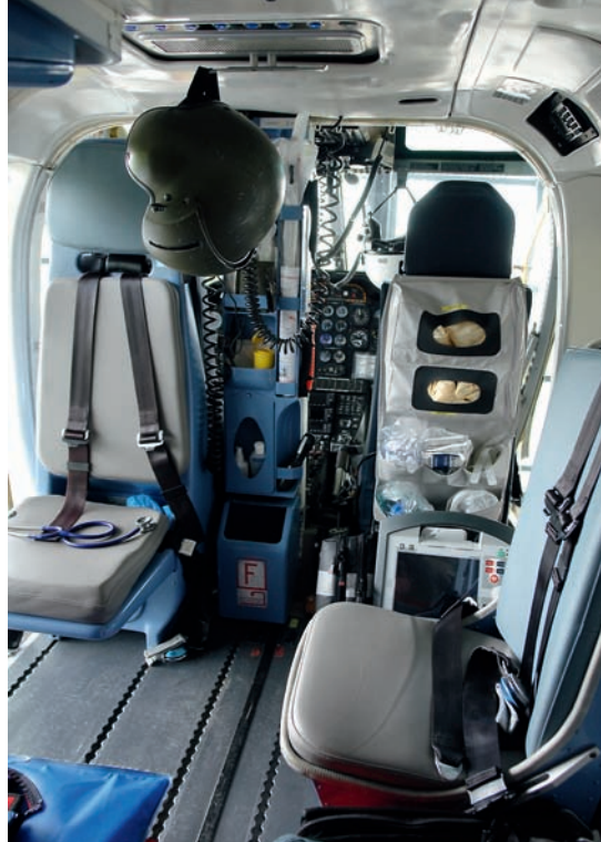
Abb. 5: Der O 2 -Vorrat in seiner Spezialhalterung
