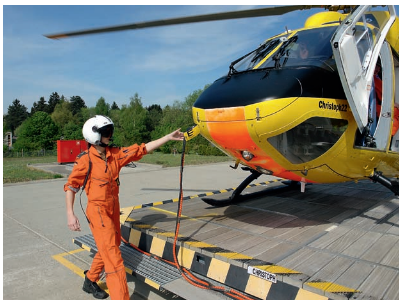
Abb. 10: HEMS TC beim „Outside Check“ und dem Trennen der externen Stromversorgung des RTH
