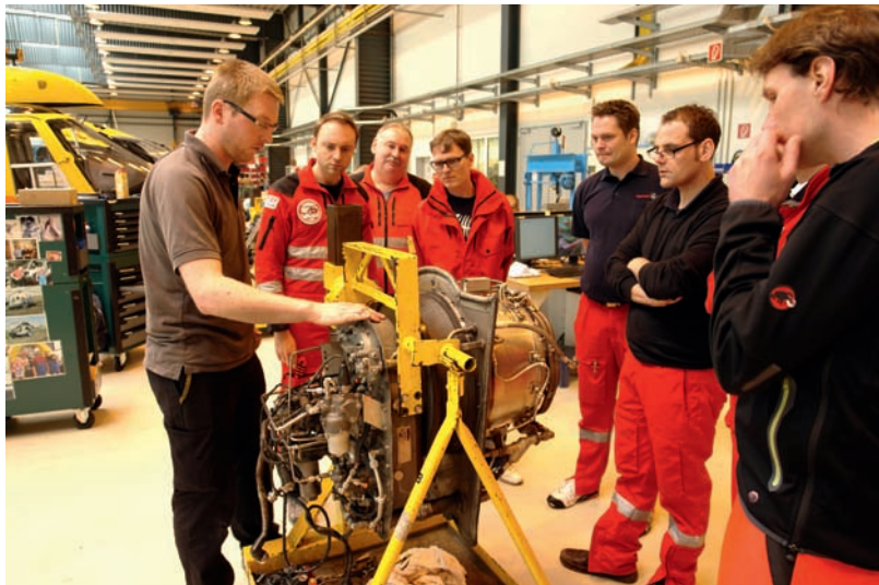
Abb. 11: Kompakter Turbinenmotor eines Hubschraubers im ausgebauten Zustand
